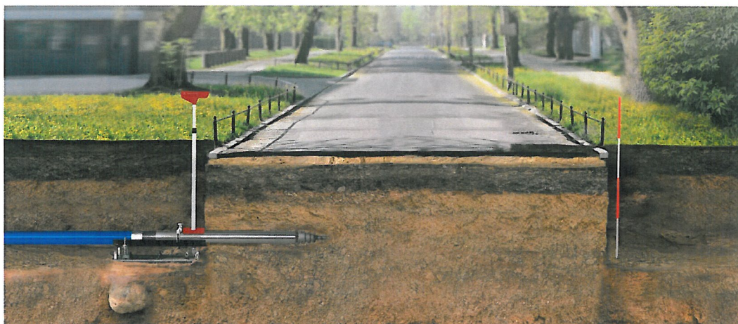
Rys. 1 Rozpoczęcie pracy z wykopu startowego, celowanie
