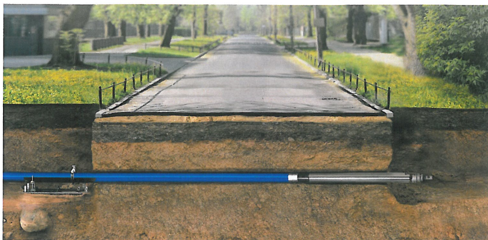
Rys. 2 Końcowa faza przecisku, kret osiąga wykop docelowy
